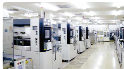
裏面研磨・レーザーグレーピング・ウエハダイシング
