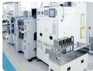
レーザーはんだ実装設備
