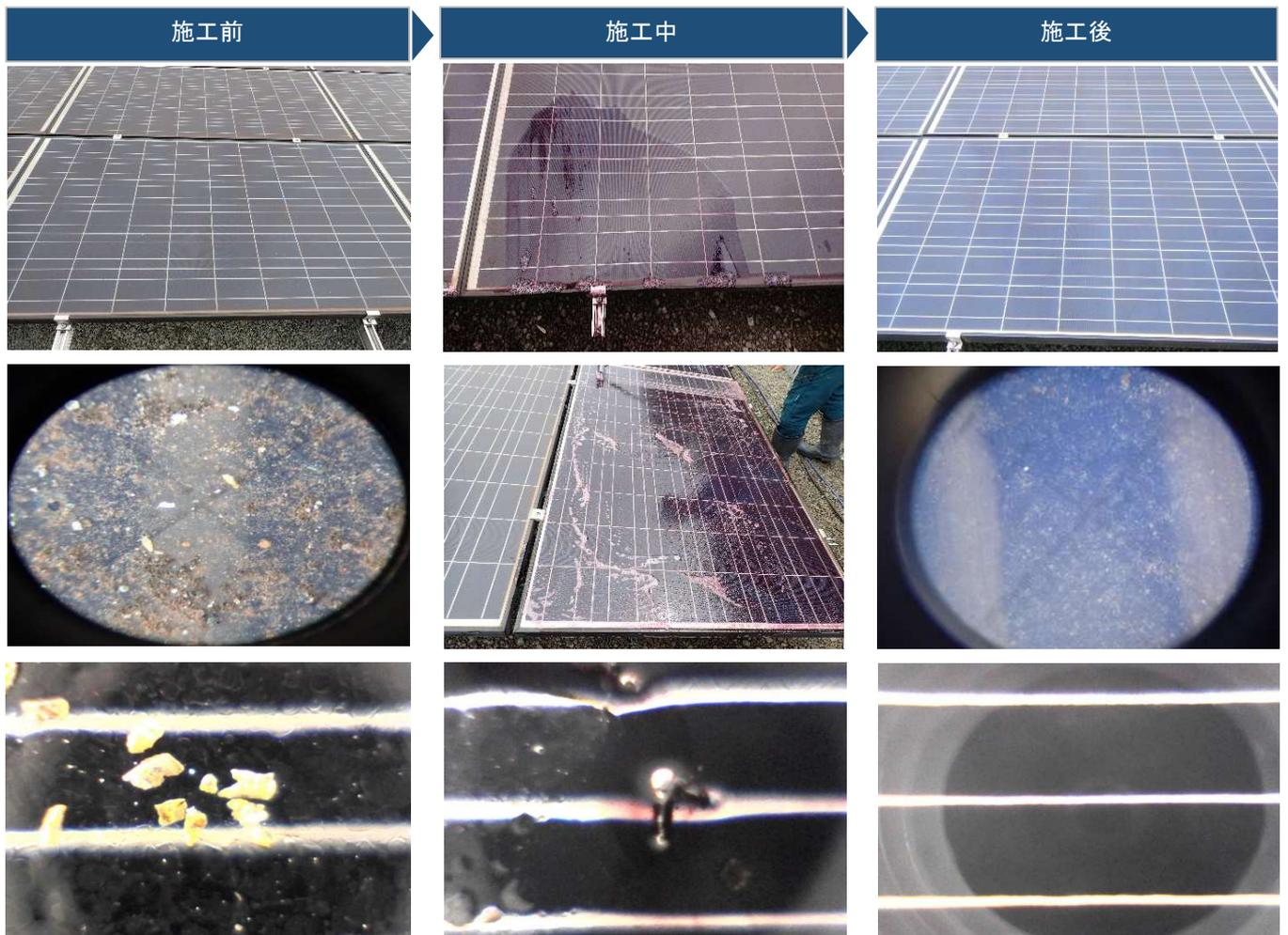
パネル表面に刺さり酸化・膨張した鉄粉の状態。
